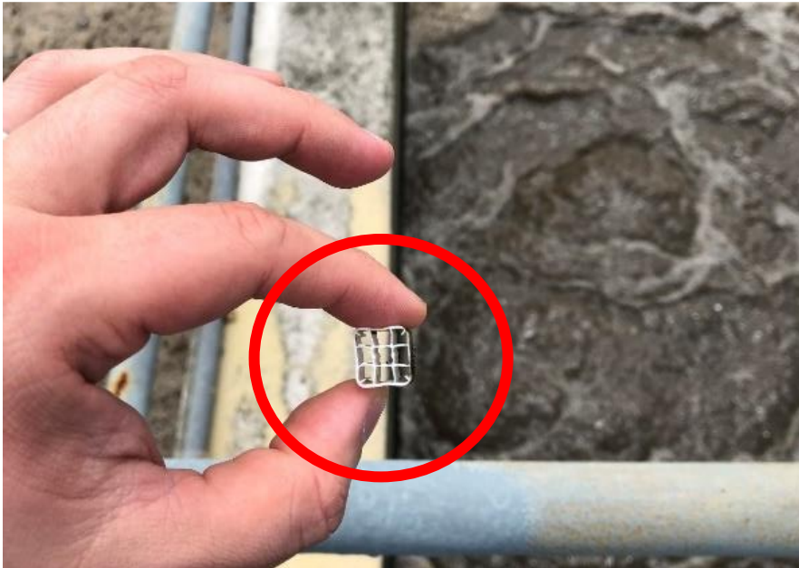
Fotografía 8. Portadores móviles de biomasa implementados en el reactor secundario.
