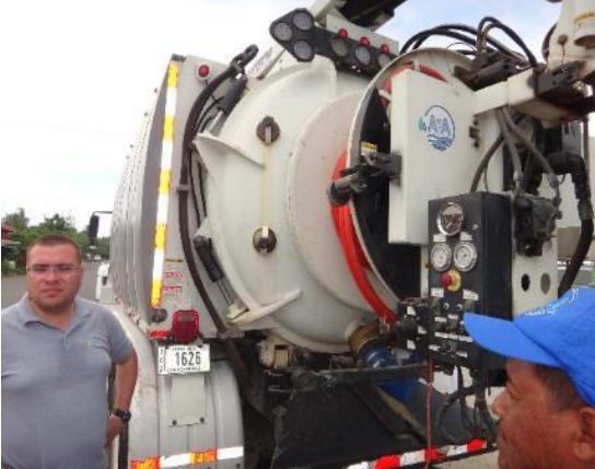
Fotografía 8 y 9. Camión hidrovaciador y colector de aguas residuales obstruido.
