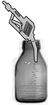
Figura 1 Colocación de la “pistola” en el recipiente de muestreo
